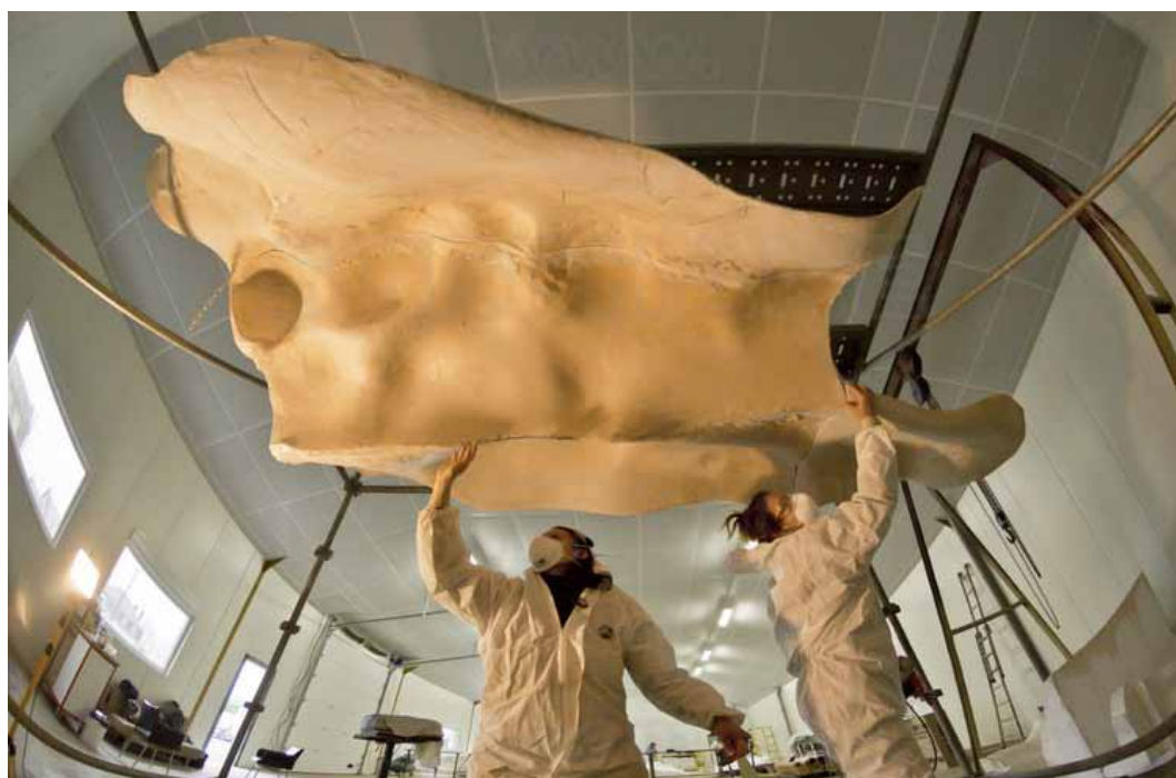
Une réalisation au millimètre près : Les relevés 3D ont permis de construire des moules permettant de réaliser des panneaux en résine et matières naturelles. © Stéphane Compoint / Résolute
