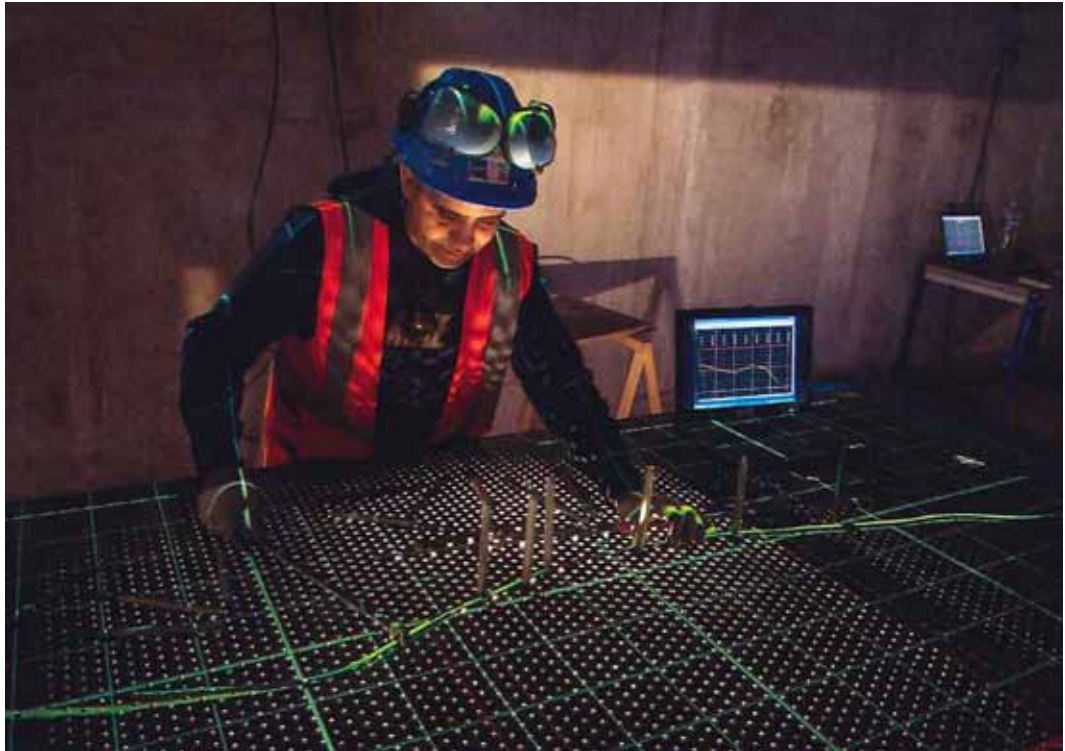
Des milliers de tiges métalliques (150 kilomètres au total) ont été façonnées à la main pour réaliser des profils dont chaque modèle est unique. © Philippe Psaila
